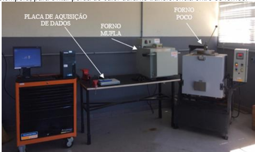
Figura 24 – Célula de tratamento térmico com forno de austenitização ao lado do forno de austêmpera, para evitar perda de calor durante transferência entre os fornos.
