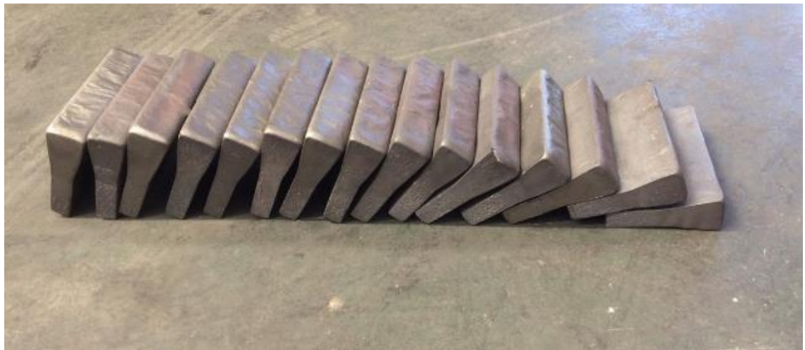
Figura 20 – Blocos Y obtidos pelo processo de fundição.
