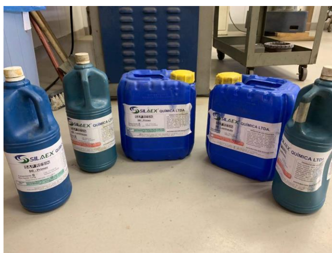
Figura 18 - Resinas Primer e Laminação utilizadas nas vigas
