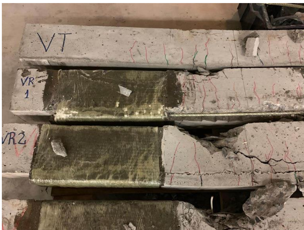
Figura 37 - Flambagem da armadura de aço na zona comprimida e barra de fibra de vidro intacta
