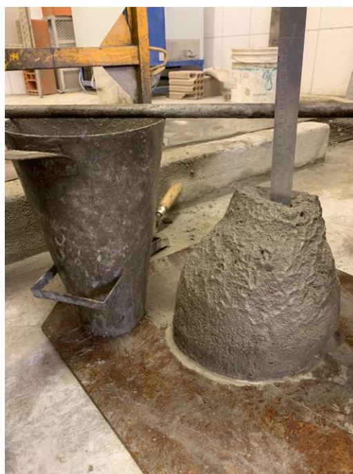
Figura 23 - Abatimento de cone referente à betonada do dia 26/04/2019
