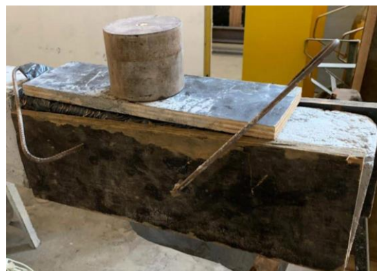
Figura 33 – (a) Passagem de rolo de metal para reduzir os vazios e (b) Tábuas de madeiras colocadas para ajudar na fixação da manta
