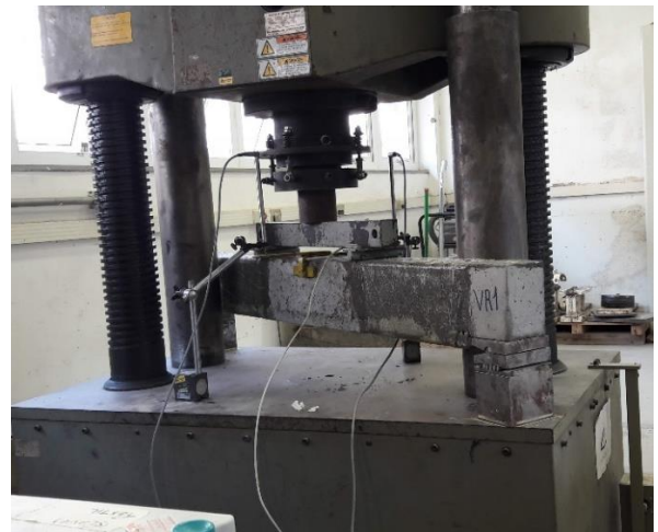
Figura 35 – (a) Posicionamento da viga VT para ensaio; (b) Ensaio da viga VR1
