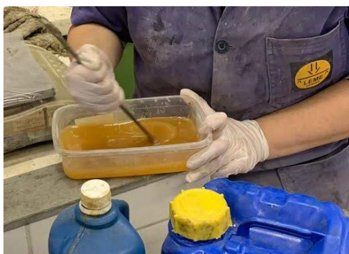
Figura 31 - Mistura manual dos materiais bi componentes da resina
