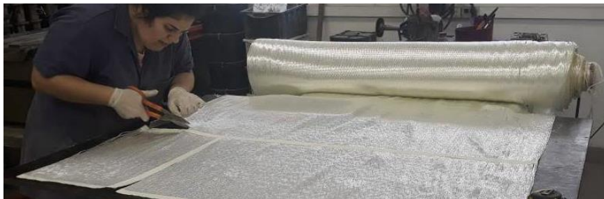
Figura 29 - Corte da manta de fibra de vidro
