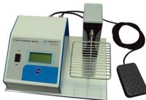
Figura 9. Equipamento Grip Strength, utilizado para o teste de força de preensão Fonte: Disponível em: < https://insightltda.com.br/?product=eff-305-grip-strenght-meter-ratos-e-camundongos >. Acesso em: 17 de fev. de 2019.
