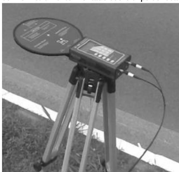
Figura 6. Medição com o instrumento montado sobre tripé conectado ao leitor remoto.
