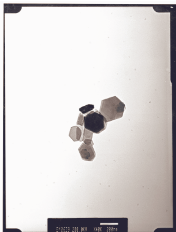
Figura 16 - Fotomicrografia obtida no MET mostrando as plaquetas euédricas de caulinita. A barra de escala corresponde a 200 nm.
