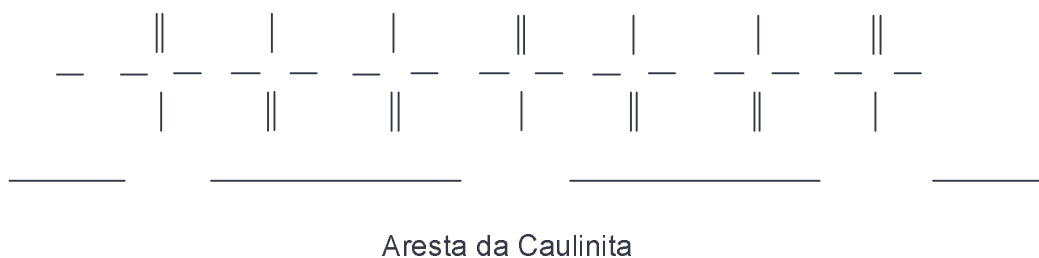
Figura 11 - Modelo esquemático da adsorção do ânion polimetafosfato-Na nos sítios Al^{3+} da superfície da caulinita (Olphen, 1977).
