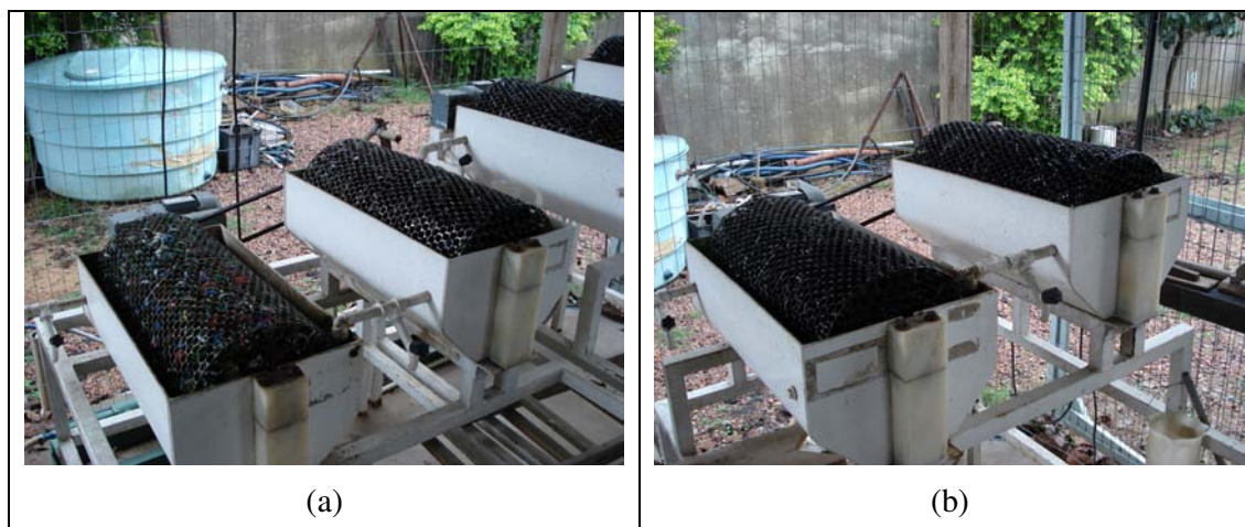
Figura 4.7 – Sistemas de CBR utilizados na pesquisa: (a) CBR 1, preenchido com tampas e gargalos de garrafas PET; (b) CBR 2, preenchido com anéis Pall.
