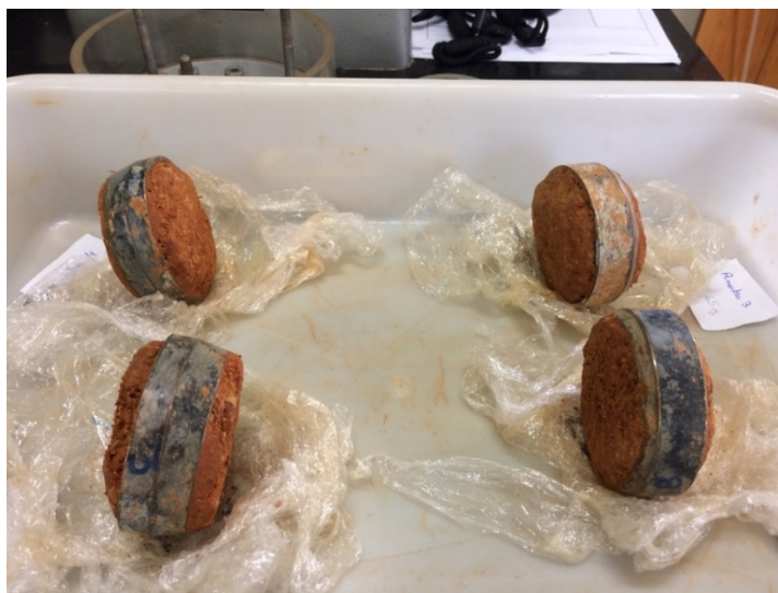
Figura 28 – Secagem ao ar das amostras
