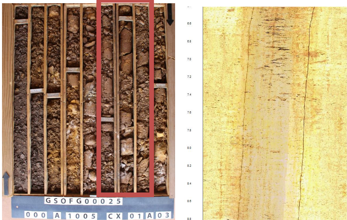
Figura 3.5 - Foto de testemunhos do furo GSOFG00025 na Mina Gongo Soco. O trecho deteriorado assinalado em vermelho, aparece na imagem de OPTV à direita.
