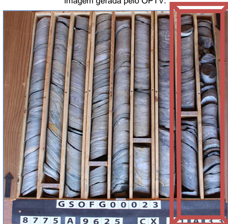
Figura 3.25 - Testemunho do furo GSOFG00023, sem condições de identificar as aberturas vistas na imagem gerada pelo OPTV.
