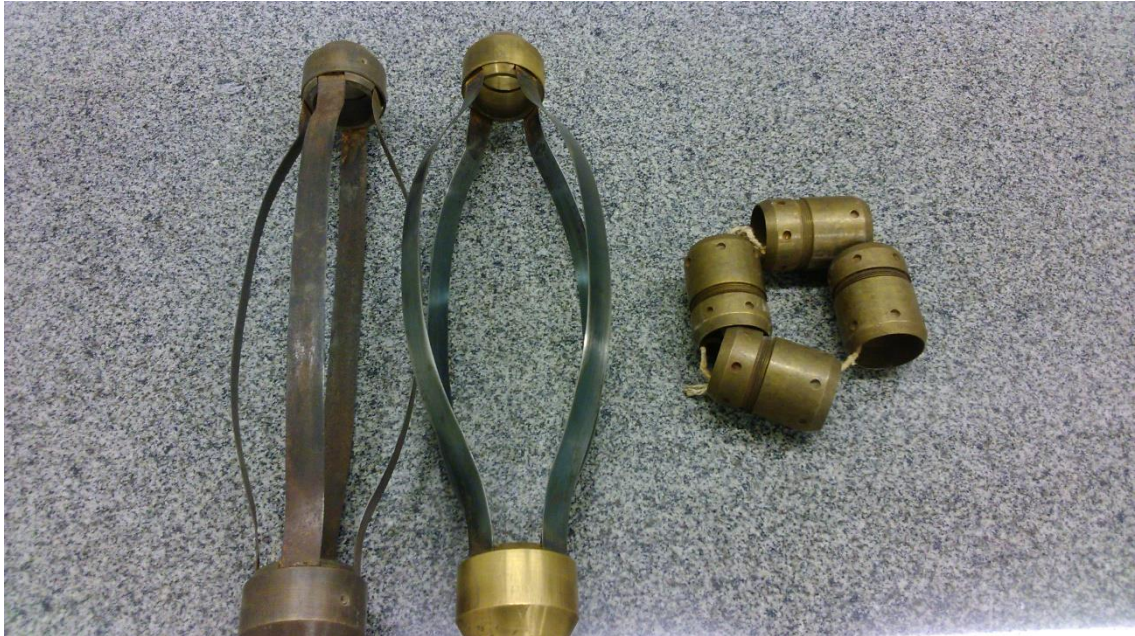
Figura 2.7 - Componentes para a centralização da sonda OPTV.
