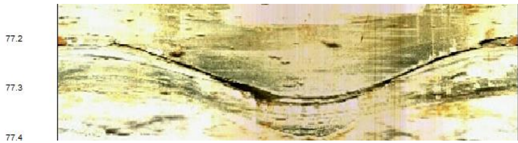
Figura 3.20 - Imagem do furo GSOFG00025, com rugosidade de classe “lisa”.
