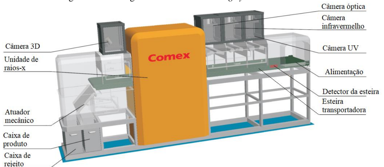
Figura 9. Tecnologia Multichannel scanning system da Comex®.
