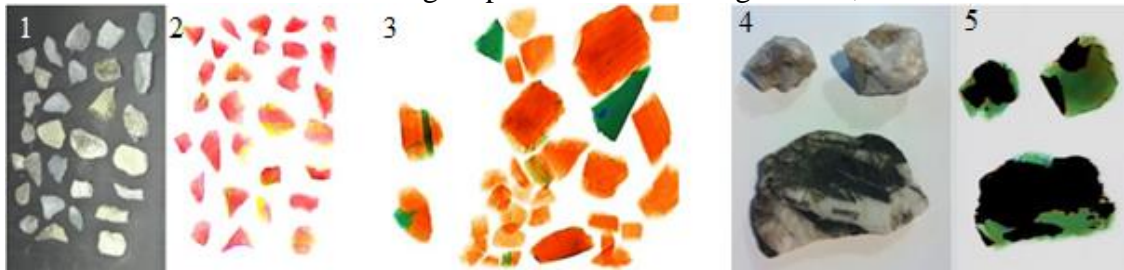
Figura 8. Imagens obtida por sensor raios-x em minério de ferro-cromo 1,2 e carvão 3, e por sensor de imagem para minério de tungstênio 4,5.
