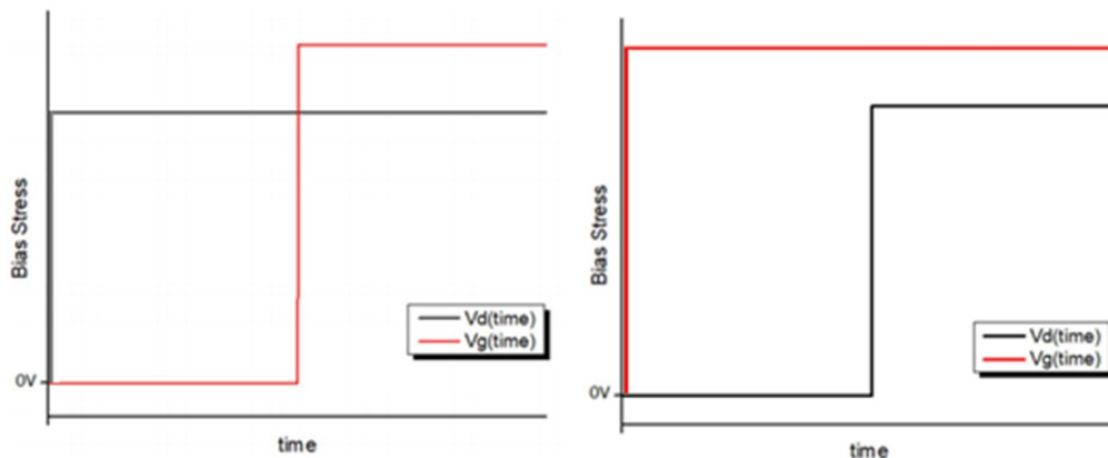
Figura 32 - Estresse contínuo ora em V_D ora em V_G e degrau positivo aplicado no sinal oposto. Fonte mantida em 0V.
