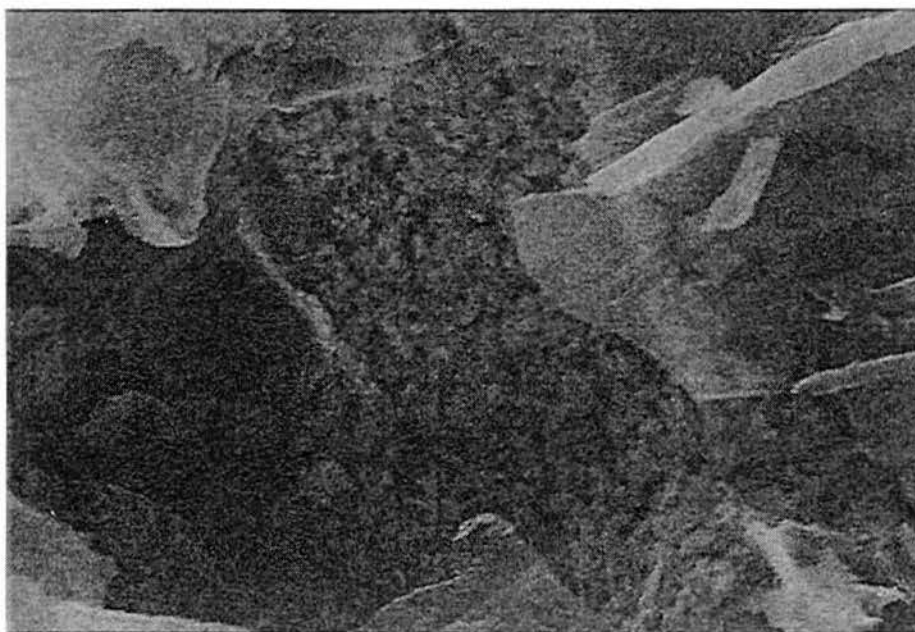
Figura 24. Face inferior da folha, fotomicrografia obtida por MEV, cristais de cera visíveis à direita, aumentos = 2065x.
