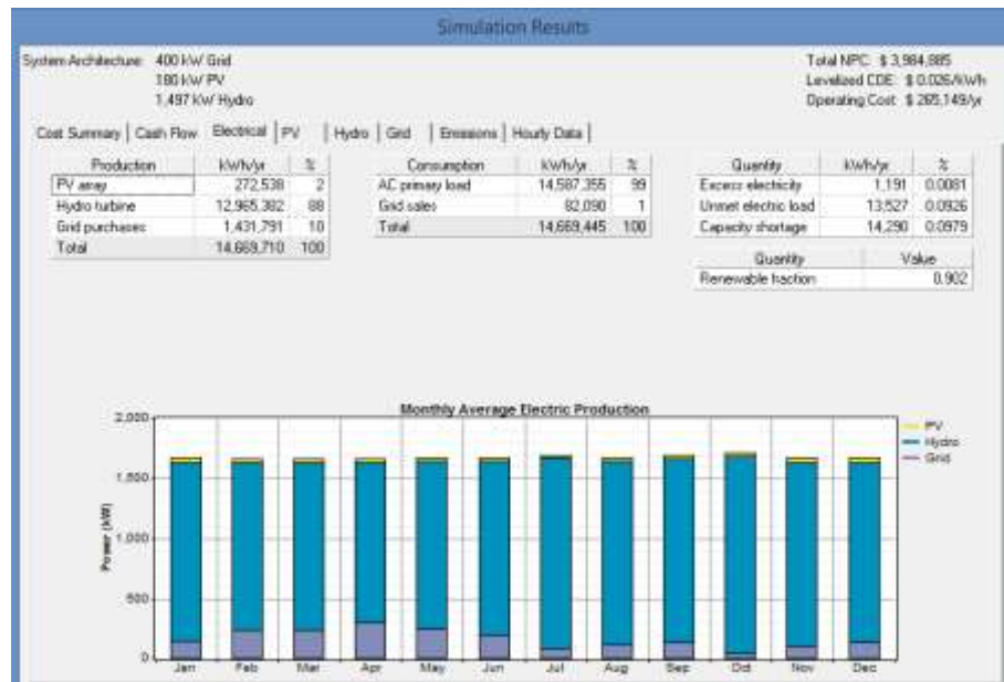
Figura 22. Resultados das simulações com médias mensais de geração de energia elétrica ao longo do ano.
