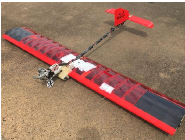
Figura 27: Aeronave JF-01 com o sistema de aquisição de dados instalado.
