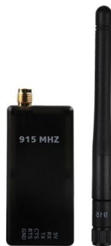
Figura 20: Transmissor e receptor de rádio frequência de 915MHz.
