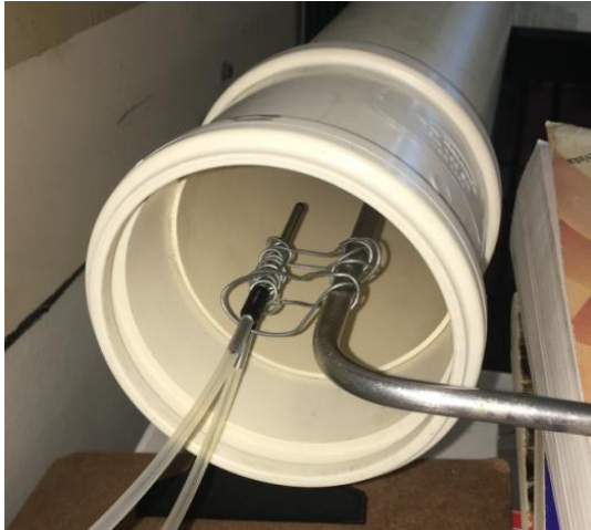
Figura 11: Tubo de Pitot (à esquerda da figura) conectado ao sensor MPX7002DP. Tubo de Pitot (à direita da figura) conectado ao manômetro.
