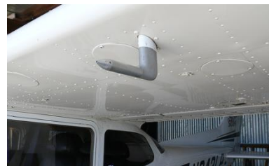
Figura 2: Tubo de Pitot instalado em uma aeronave comercial.
