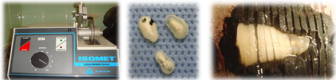
Figura 3 Disco em baixa rotação (Isomet, Buehler Ltd, Lake Bluff, IL, USA), sob refrigeração constante, obtendo-se fatias transversais com, aproximadamente, 0,7mm de espessura.
