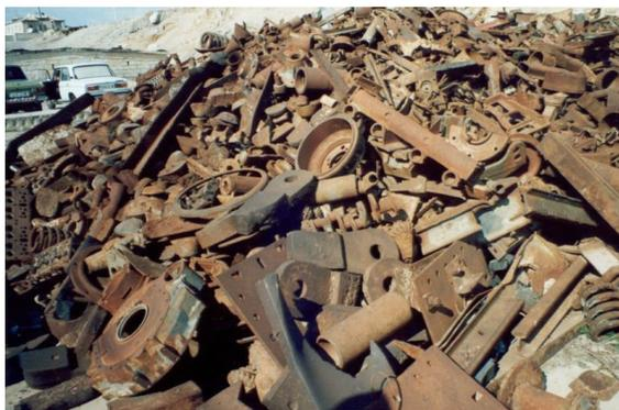
**Figura 1.** Sucata pesada e de ferro fundido.
