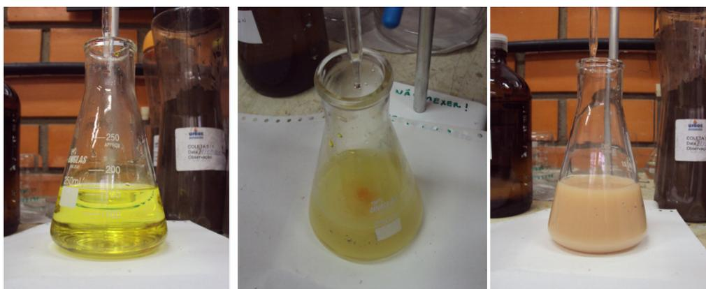
**Figura 41.** Ponto inicial à esquerda, ponto em andamento ao centro e ponto final à direita da titulação pelo método de Mohr.
