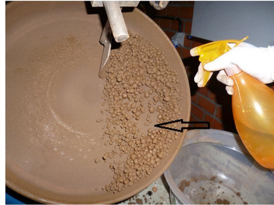
**Figura 46.** Saturação de água e formação de “vazio” ao centro, assinalado com seta.
