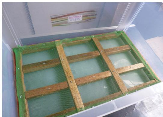
**Figura 58.** Estrado para sustentação das pelotas durante os testes.
