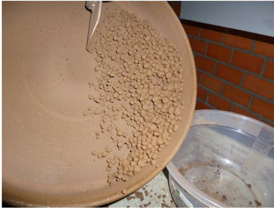
**Figura 45.** Conformação das pelotas.
