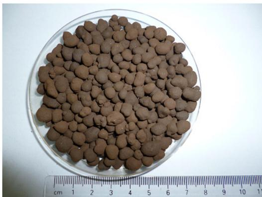
**Figura 48.** Pelotas produzidas com PAE de usina siderúrgica ACSS.
