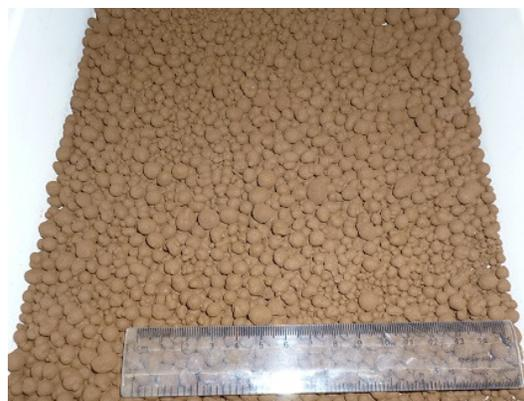
**Figura 49.** Pelotas produzidas com PAE de usina siderúrgica ACCS.
