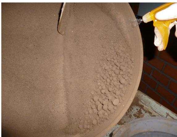
**Figura 44.** Início do processo de pelotização da mistura PAE +  $\text{CaO}$ .
