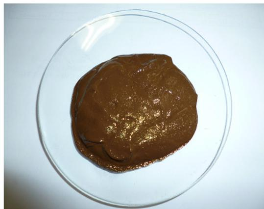
**Figura 38.** Formação de lama estável de PAE com alto conteúdo de umidade.
