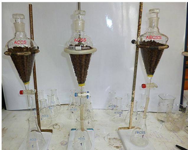
**Figura 53.** Montagem para execução dos ensaios de lixiviação das pelotas em nível de laboratório: à esquerda ACCS, ao centro ACSS e à direita AECSS.
