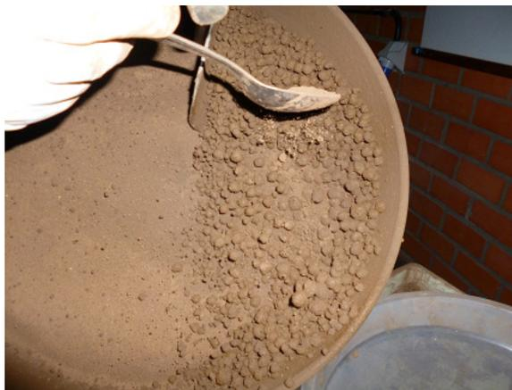
**Figura 47.** Efeito da adição de mistura seca às pelotas úmidas.
