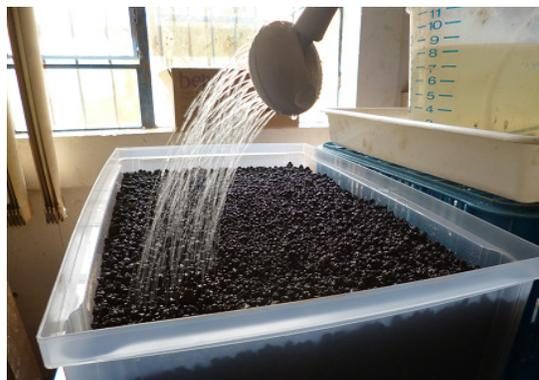
**Figura 60.** Aspersão das pelotas com água ou soluções salinas.
