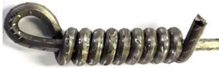
Figura 4.1 Detalhamento do ensaio de dobramento realizado no material.
