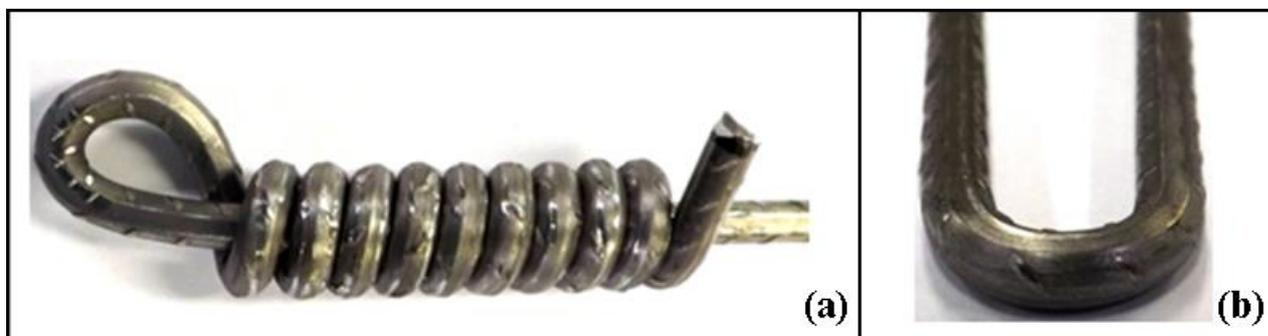
Figura 3.2 Amostras de ensaio de enrolamento (a) e dobramento (b).
