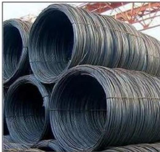
Figura 2.7 Fio-máquina. Fonte: Gerdau Riograndense.
