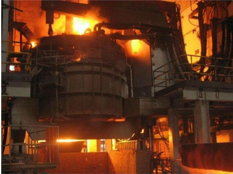
Figura 2.2 Forno Elétrico a Arco. Fonte: GERDAU (2013)
