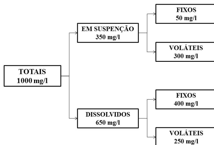
Figura 5 – Valores médios de concentração de sólidos no esgoto sanitário bruto
