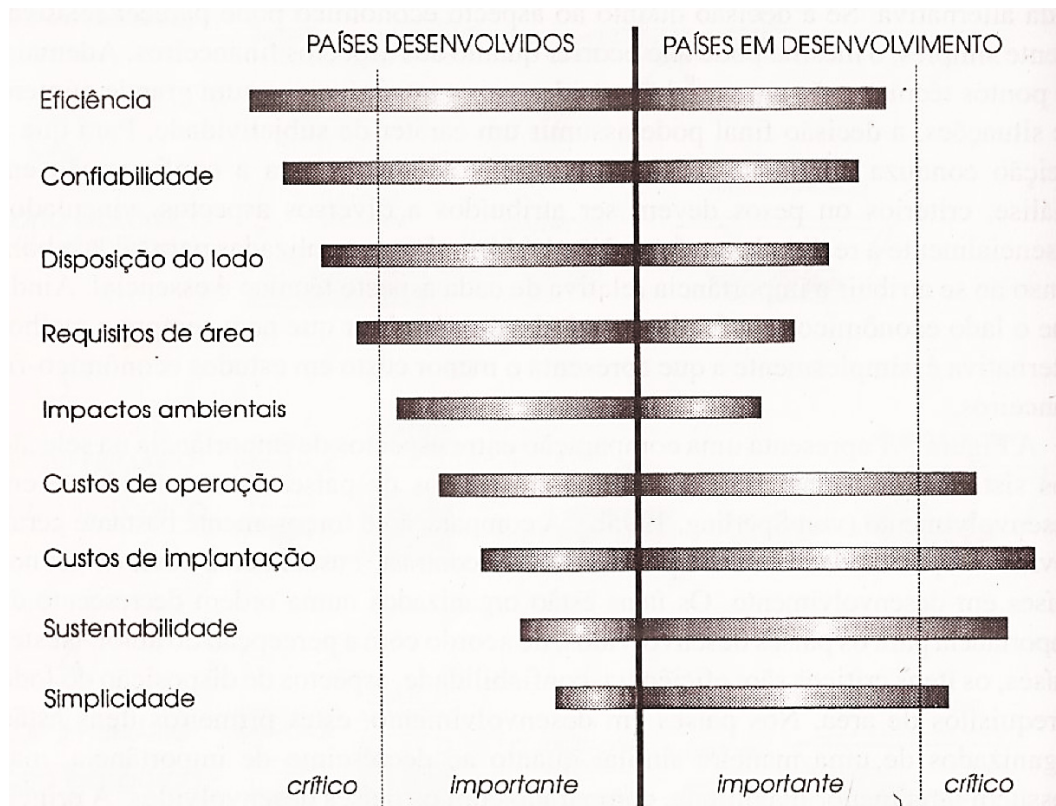
Figura 6 – Aspectos críticos na seleção do sistema de tratamento de esgoto em países desenvolvidos e em desenvolvimento
