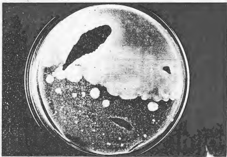
Fig.34 Plaqueamento realizados da solução de água do mar sintética diluída a 1,5% com bactérias sem o hexametáfosfato de sódio.
