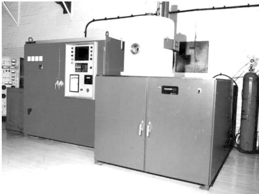
Figura 3.2 – Reator a plasma Klockner 45 KW usado para a nitretação das amostras.
