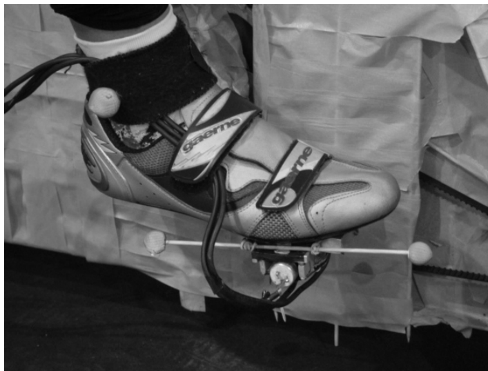
Figura 3.2: marcadores reflexivos utilizados para o cálculo de \beta
