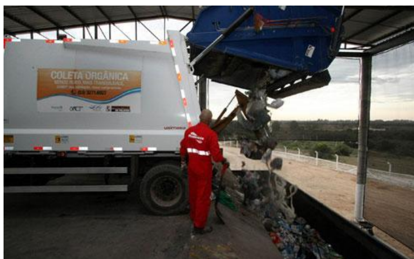
Figura 15 – Transbordamento de caminhão coletor direto Fonte: Correio do Povo, 2012.
