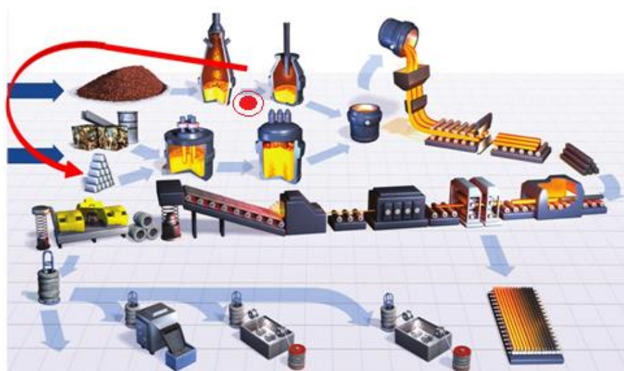
Figura 30 – Processo integrado e semi-integrado de produção de aço e seus produtos
