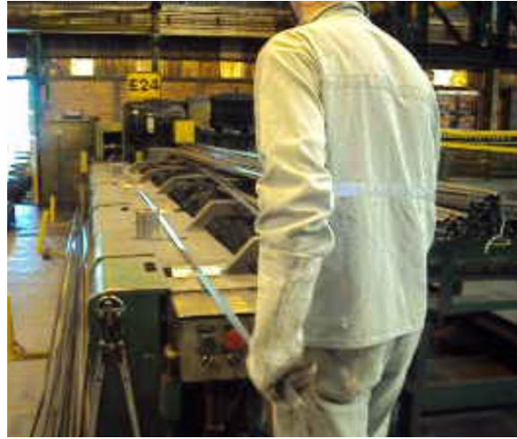
Figura 3: operação 1 – inserir barras na máquina, executado por apenas um operador
