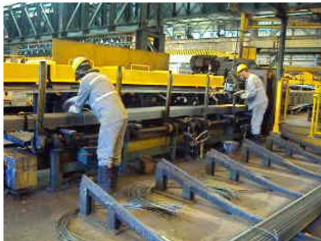
Figura 4: operação 4 – enfeixamento, que é executado por dois operadores
