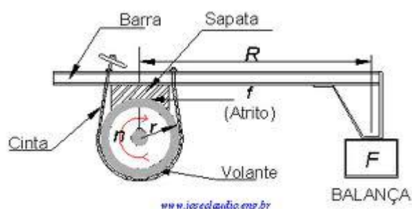
Figura 5.2 - Dinamômetro Prony. Fonte (www.joseclaudio.eng.br)
