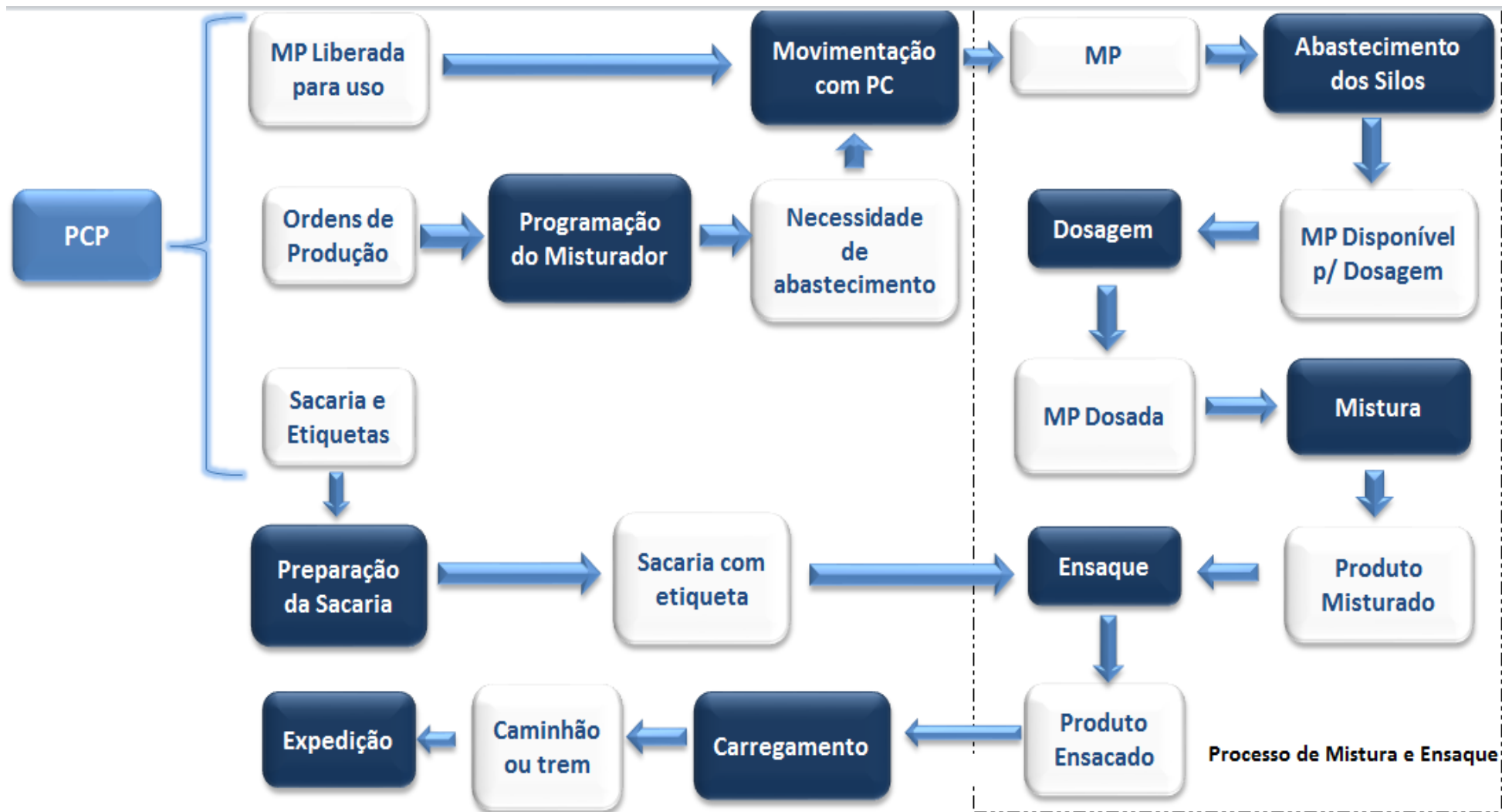
Figura 7 - Fluxograma de Ensaque e Mistura
