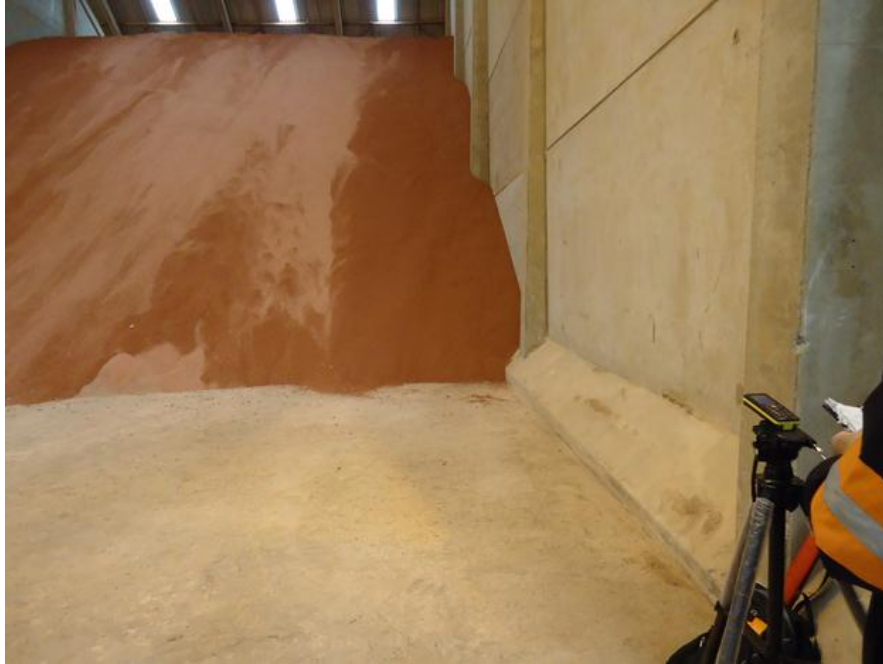
Figura 19 - Medição de volume com trena a laser e prancheta
