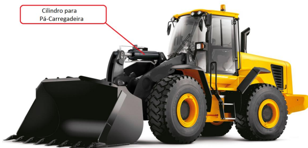
FIGURA 13 - Exemplo de aplicação cilindro hidráulico: Pá-Carregadeira
