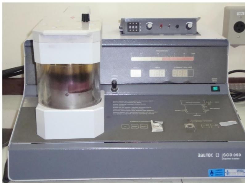
**Figura 7:** Metalizadora modelo BAL-TEC SCD050: equipamento que recobre amostras com uma fina camada de material condutível (Arquivo pessoal: fotografia registrada em CME-UFRGS).
