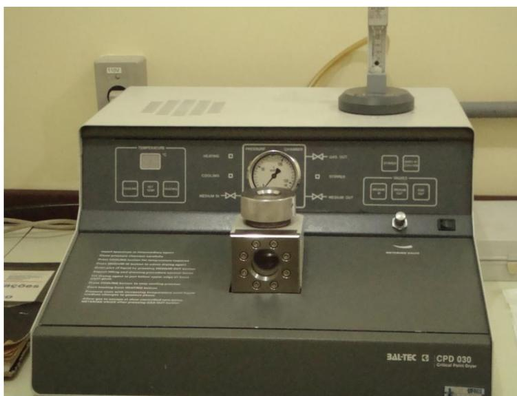
**Figura 6:** Câmara de ponto crítico utilizada para secagem de amostras biológicas modelo BAL-TEC CPD030. (Arquivo pessoal: fotografia registrada em CME-UFRGS).
