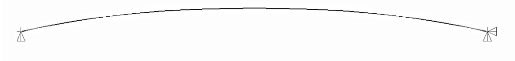
Figura A.4. Deformação do primeiro modo de flambagem da barra, sendo coeficiente de carga de flambagem 1.0.
