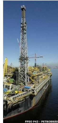
Figura 9.16. Torre de queima com seção retangular.
