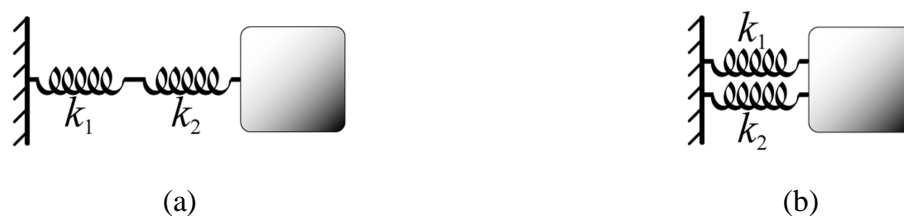
Figura 1.2 – Representação de um sistema massa-mola com: (a) Molas em série e (b) Molas em paralelo 20
