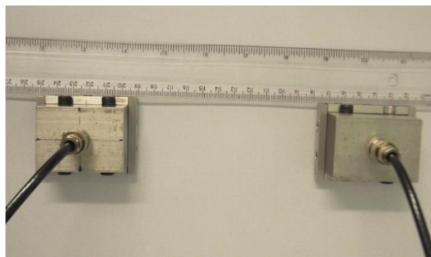
Figura – 21: Foto dos transdutores desenvolvidos com uma régua para escala.
