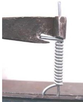
Figura 24. Arame apresentando forma correta após ensaio.
