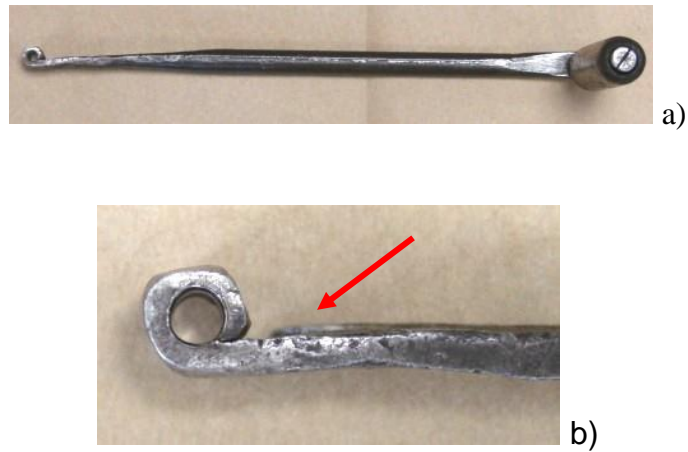
Figura 16. Dispositivo de ensaio de enrolamento. a) Visão geral b) Detalhe do dispositivo.
