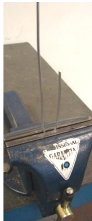
Figura 18. Fixação do corpo de prova na morsa.
