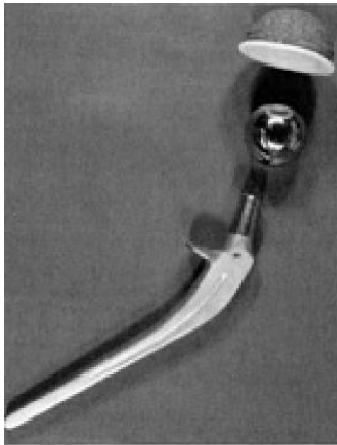
Figura 3 - Prótese de fêmur de liga a base de cobalto (cobalto-cromo-molibdênio).
