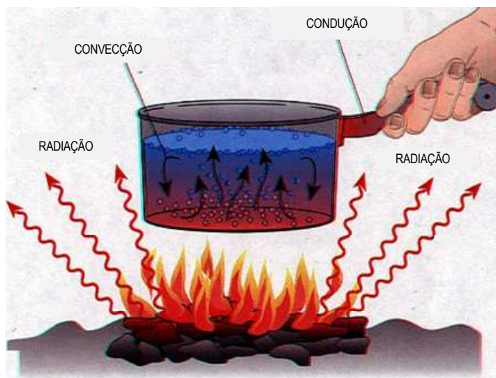
Figura 2.5 - Representação esquemática dos mecanismos de transferência de calor. (Fonte: adaptado de www.physics.louisville.edu/cldavis/phys298/notes/heat_transfer_mech.html )
