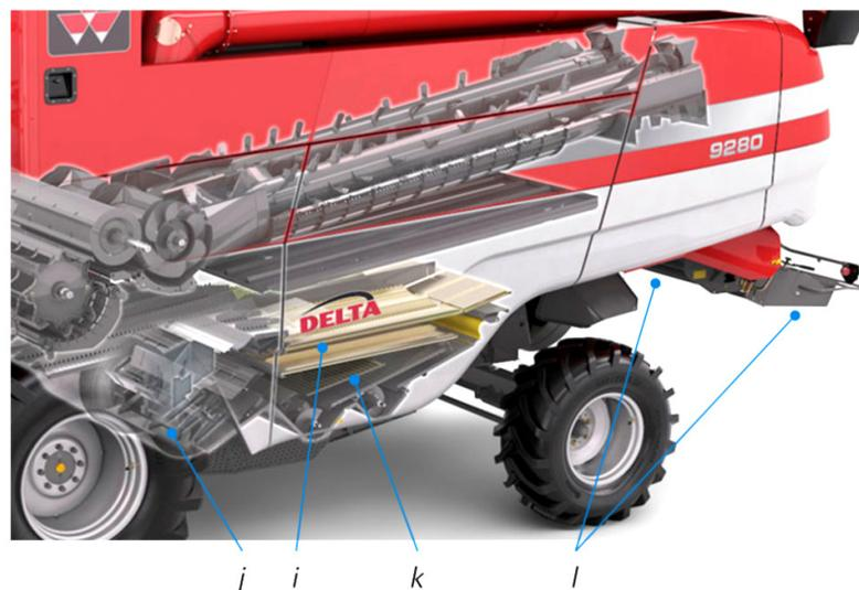
Figura 10 - Sistema de separação de uma máquina colheitadeira de grãos.
