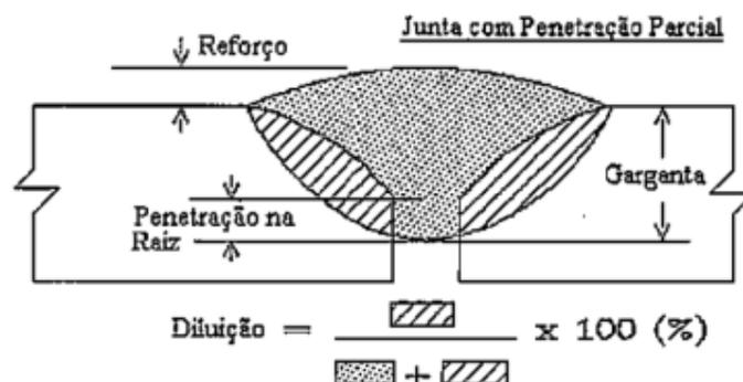
Figura 32 - Zona fundida e metal de base de uma junta soldada.
