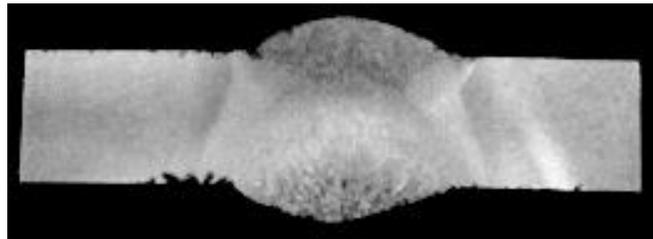
Figura 55 - Macrografia de uma junta soldada de topo mostrando o tamanho do reforço da solda e sua penetração.
