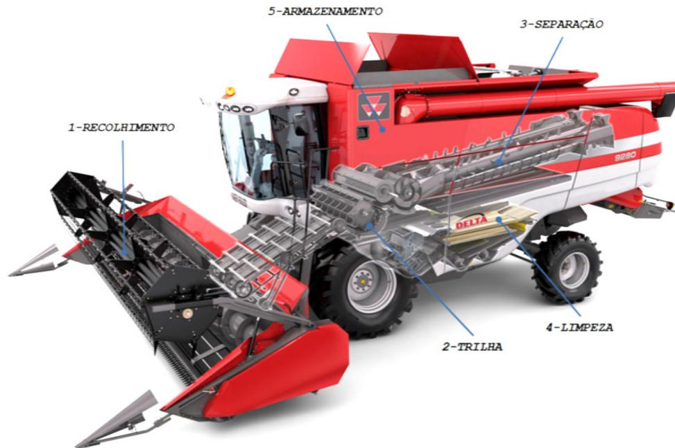
Figura 6 - Principais sistemas de uma máquina colheitadeira de grãos.
