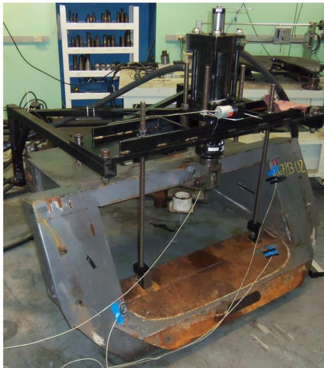
Figura 48 - Instalação da bancada de fadiga para o conjunto produzido atualmente.
