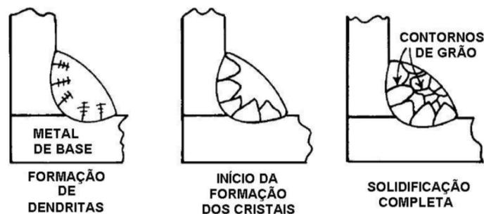
Figura 30 - Etapas e características do processo de solidificação de uma junta soldada.
