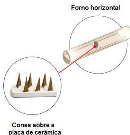
Figura 3.1- Detalhe da posição da placa e dos cones no forno tubular
