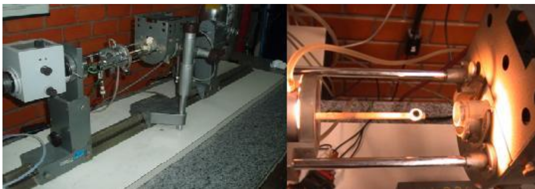
Figura 3.3 – Microscópio de Aquecimento (DIN 51730)
