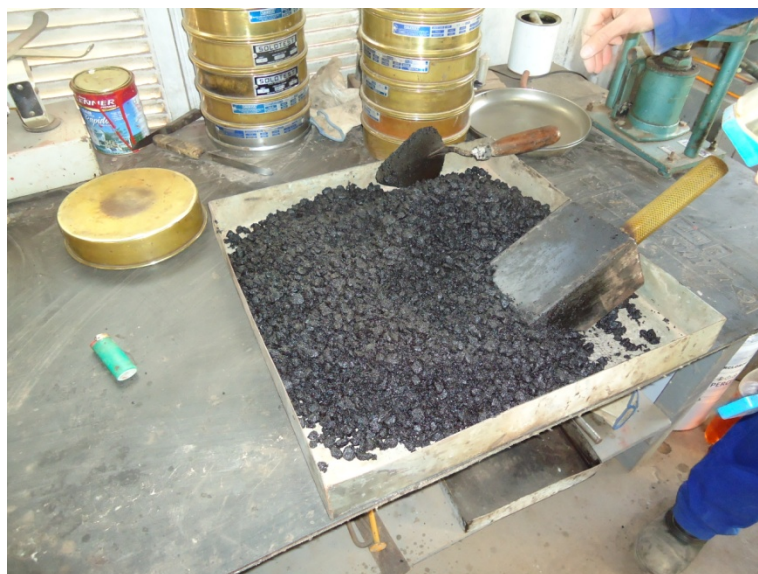
Figura 26: Amostra da mistura tipo SMA retirada da usina de asfalto
