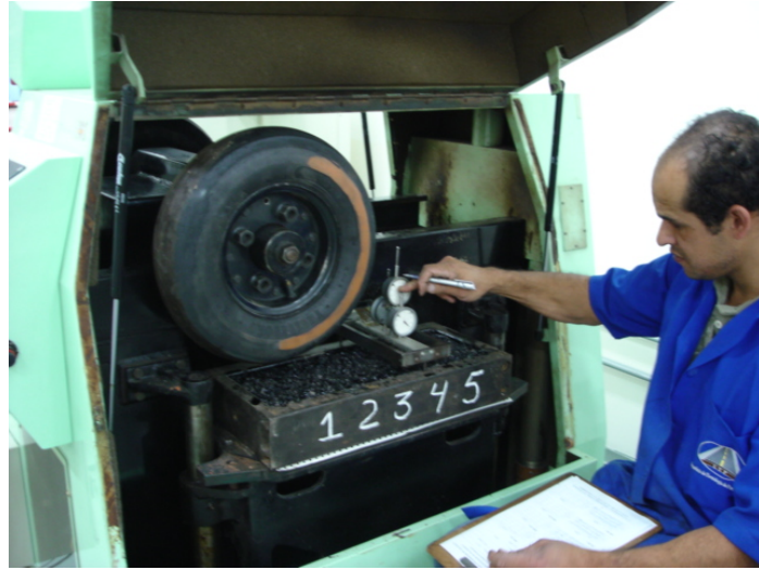
Figura 20: Simulador de tráfego LCPC instalado no LTP-EPUSP
