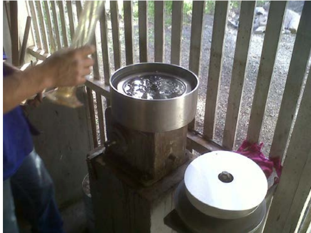
Figura 27: Realização do ensaio de extração de betume
