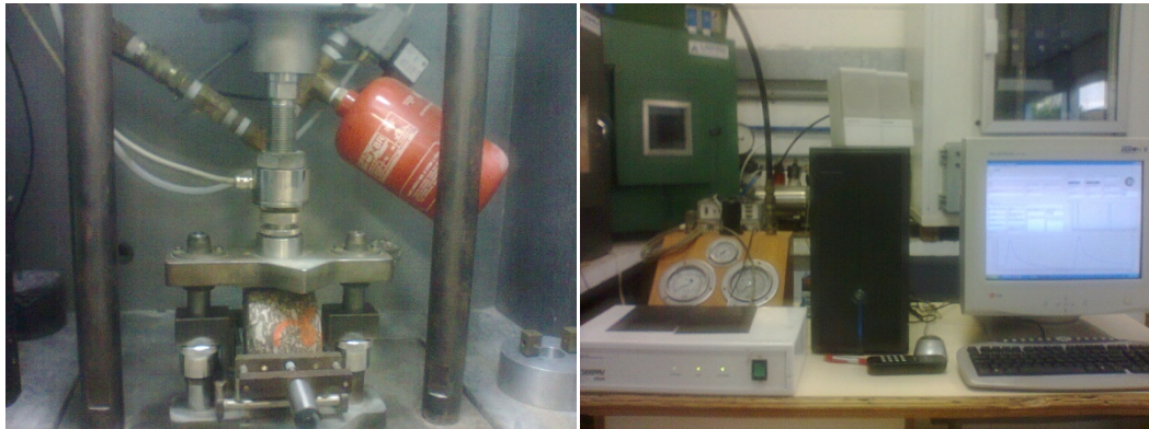
Figura 18: Equipamento para realização do ensaio de módulo de resiliência
