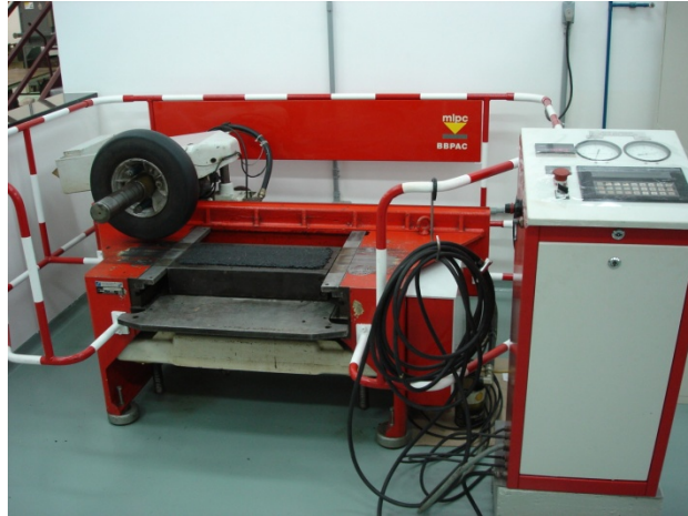
Figura 19: Mesa compactadora LCPC instalada no LTP-EPUSP
