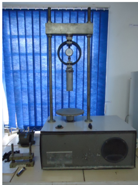
Figura 17: Prensa para realização do ensaio de resistência a tração na compressão diametral
