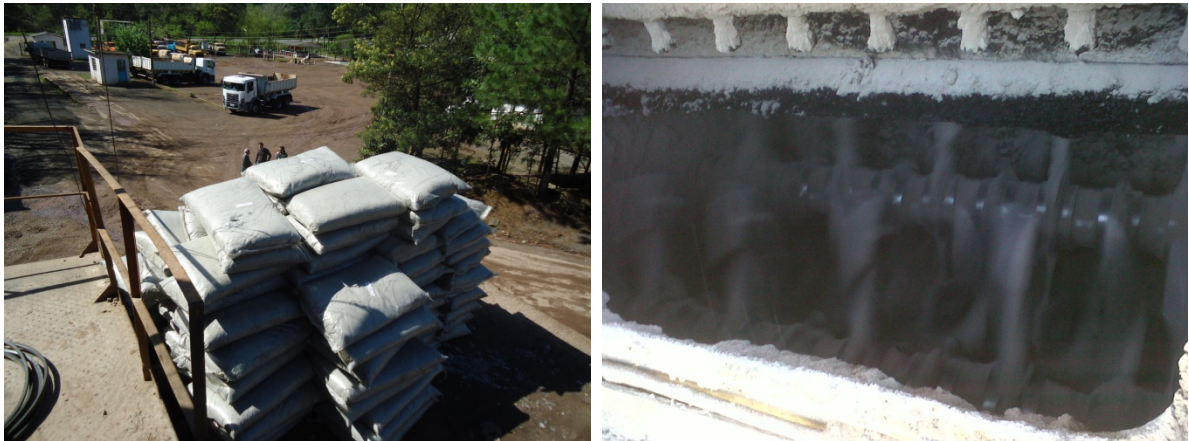
Figura 24: Processo de inserção das fibras na mistura, (a) saco de fibra dosado para uma tonelada da mistura e (b) janela de colocação das fibras
