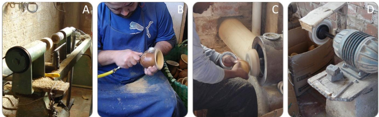
Figura 15 – Beneficiamento do porongo realizado na Fábrica de Cuias Pires, em Santa Maria, RS. (A) motor de rotação para lixamento da parte interna; (B) gravação de desenhos com buril; (C) colocação do bocal de alumínio e (D) motor de alta rotação para polimento com cera.
