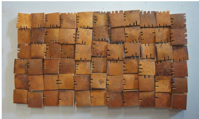
Figura 28 – Conjunto de amostras ensaiadas por impregnação a diferentes concentrações, os pequenos cortes foram utilizados para numerar amostras.
