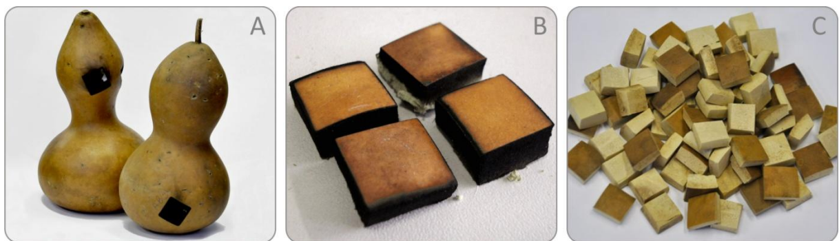
Figura 17 – Amostras de porongos seccionadas por corte a laser. (A) Frutos secos cortados, (B) seções do porongo (tamanho aproximado 15x15mm) com as bordas escurecidas pela ação do laser e (C) amostras de porongo com as bordas lixadas.
