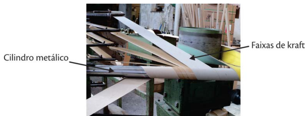
Figura 12 - Faixas de papel kraft sendo enroladas no cilindro metálico, constituindo o tubo de papelão.
