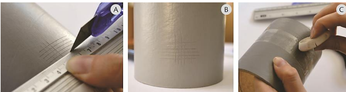
Figura 34 - Procedimento para a determinação da aderência do revestimento. (A) Realização dos cortes com estilete; (B) Grade de cortes finalizada; (C) Aplicação da fita adesiva, sendo pressionada com uma borracha.
