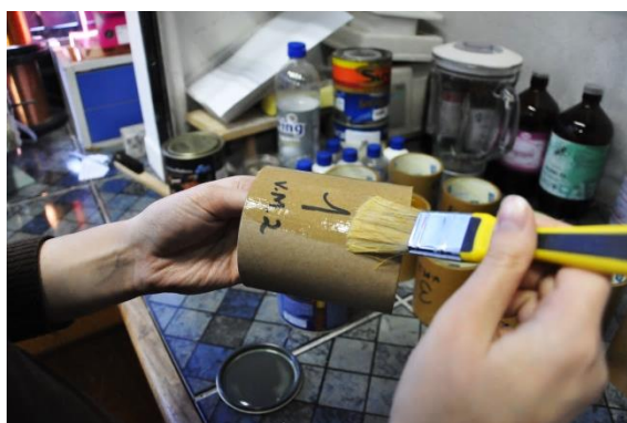
Figura 33 - Verniz sendo aplicado no tubo de papelão com o auxílio de um pincel de cerdas macias.
