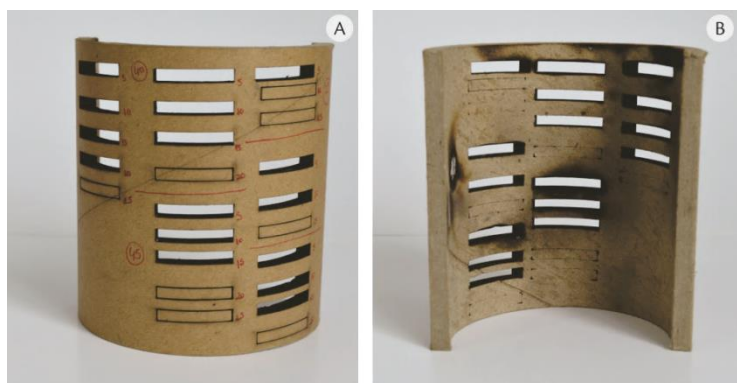
Figura 79 - Corpo de prova de 6,5mm de espessura após os cortes a laser.(A) Vista externa; (B) Vista interna.
