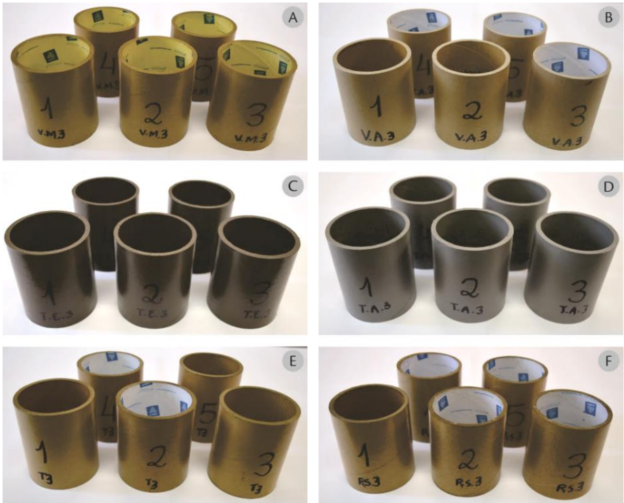
Figura 71 - (A) Corpos de prova revestidos com verniz marítimo; (B) Verniz acrílico; (C) Tinta esmalte; (D) Tinta acrílica; (E) Termolite e (F) Resina multiuso. Todos os materiais de recobrimento são à base de água.
