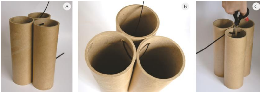
Figura 88 - União paralela em trio com abraçadeira. (A) União finalizada; (B) Detalhe da vista superior da união; (C) Simulação de desmontagem da união, cortando a abraçadeira com uma tesoura comum.
