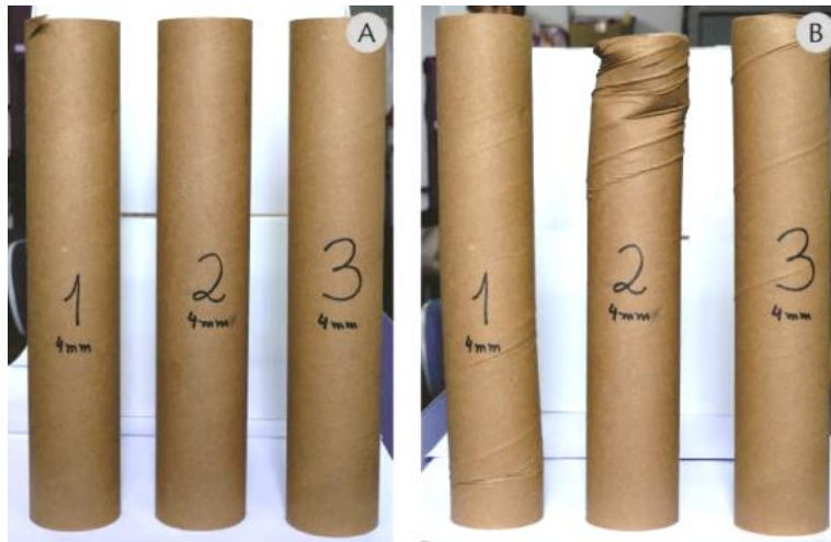
Figura 63 - Comparação entre os corpos de prova de 4mm espessura. (A) Antes do ensaio; (B) Após o ensaio de flambagem.
