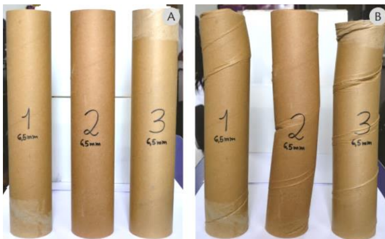
Figura 67 - Comparação entre os corpos de prova de 6,5mm espessura. (A) Antes do ensaio; (B) Após o ensaio de flambagem.
