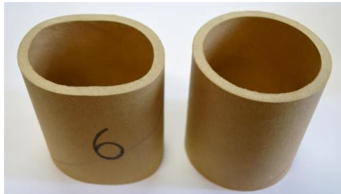
Figura 58 - À esquerda, corpo de prova após o ensaio de compressão diametral; à direita, corpo de prova não submetido ao ensaio.
