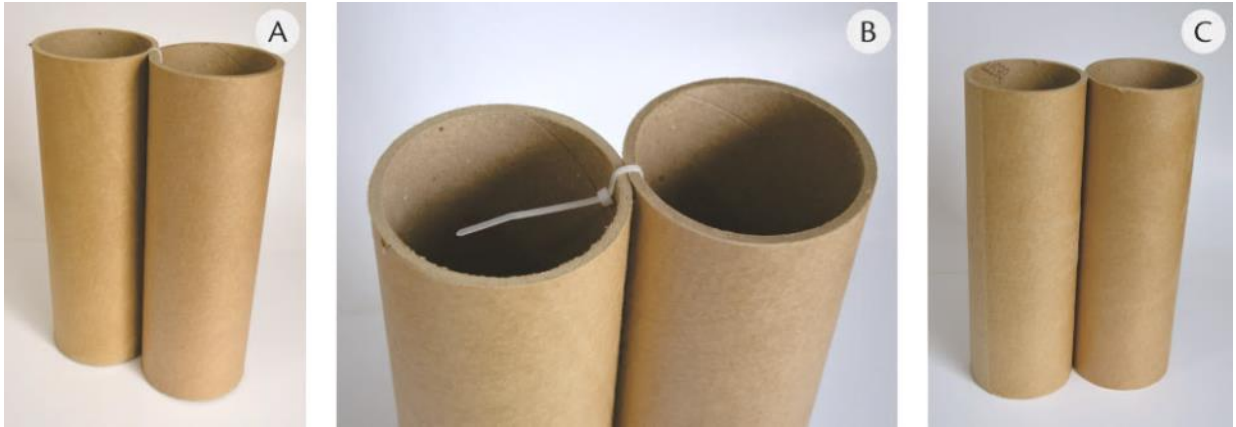
Figura 82 - União paralela em dupla. (A) União finalizada com abraçadeira; (B) Detalhe da abraçadeira; (C) União finalizada com cola.
