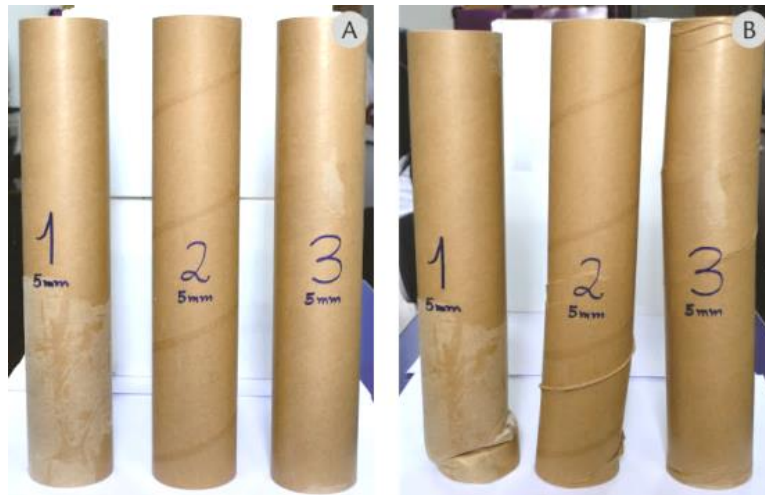
Figura 65 - Comparação entre os corpos de prova de 5mm espessura. (A) Antes do ensaio; (B) Após o ensaio de flambagem.
