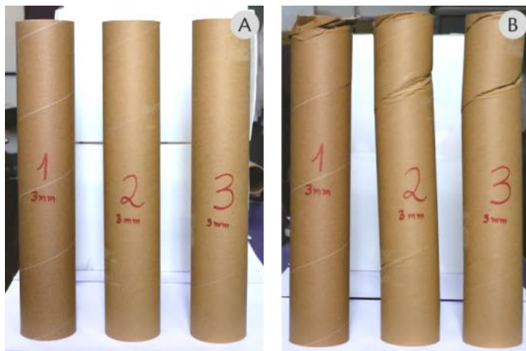
Figura 61 - Comparação entre os corpos de prova de 3mm espessura. (A) Antes do ensaio; (B) Após o ensaio de flambagem.
