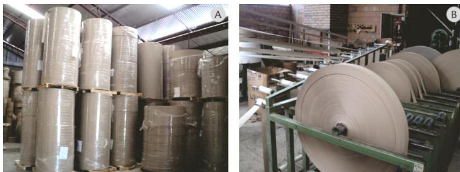
Figura 11 - Bobinas de papel kraft. (A) Bobinas de papel miolo; (B) Bobinas dispostas na máquina.
