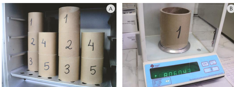
Figura 32 - (A) Corpos de prova dispostos na estufa para secagem; (B) Corpo de prova sendo pesado na balança digital de precisão.
