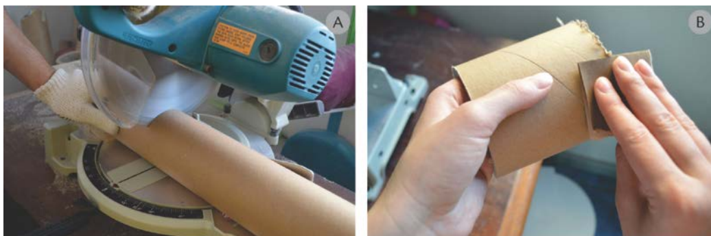
Figura 28 - (A) Corte dos corpos de prova na serra circular; (B) Retirada das rebarbas com lixa.
