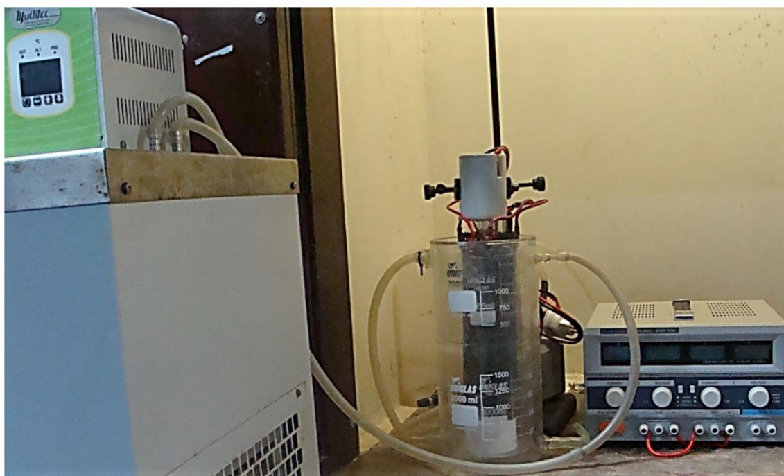
Figura 11. Foto da montagem experimental utilizada para o processo de FEO.
