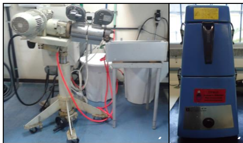
Figura 22 – Modificação das misturas poliméricas: (a) extrusora, (b) aglutinador utilizado na preparação das misturas poliméricas.
