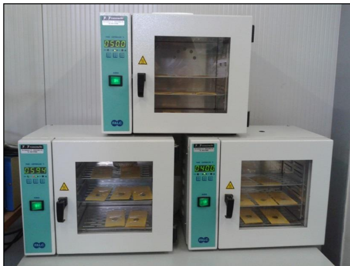
Figura 34 – Os filmes de PP dispostos na estufa estática nas temperaturas de 40, 50 e 60°C.
