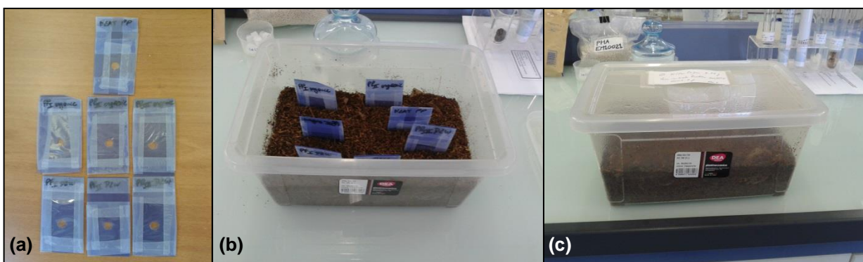
Figura 35 – Imagens das amostras de PP submetidas à biodegradação em sistema de compostagem em solo simulado: (a) amostras utilizadas na análise de FT-IR, (b) distribuição das amostras no sistema de compostagem, (c) sistema de compostagem em solo simulado em escala laboratorial.
