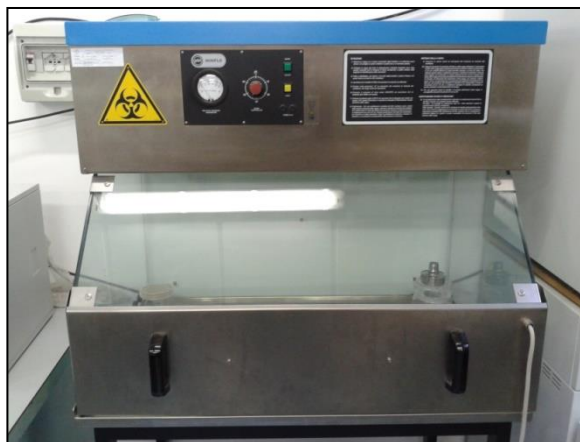
Figura 31 – Câmara de radiação UV utilizada no ensaio de envelhecimento acelerado.
