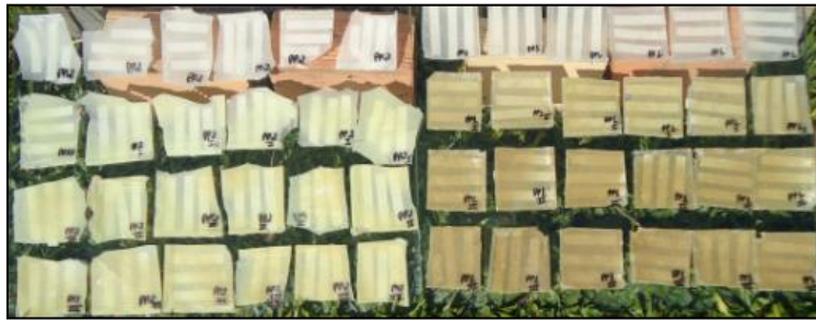
Figura 25 - Imagem da plataforma de exposição das amostras ao intemperismo natural em Porto Alegre, Brasil.
