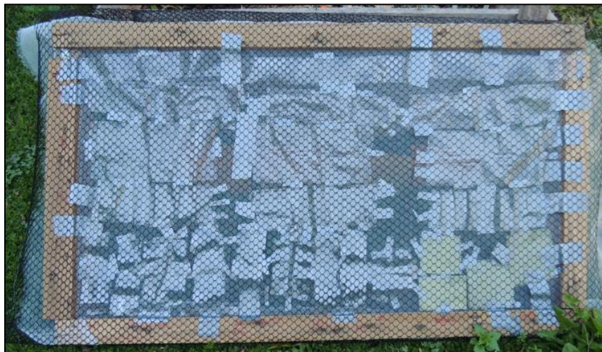
Figura 29 - Exposição das amostras submetidas ao intemperismo natural em Porto Alegre, Brasil.
