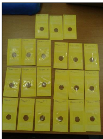
Figura 33 – Imagem das amostras de PP submetidas à termodegradação em estufa estática.
