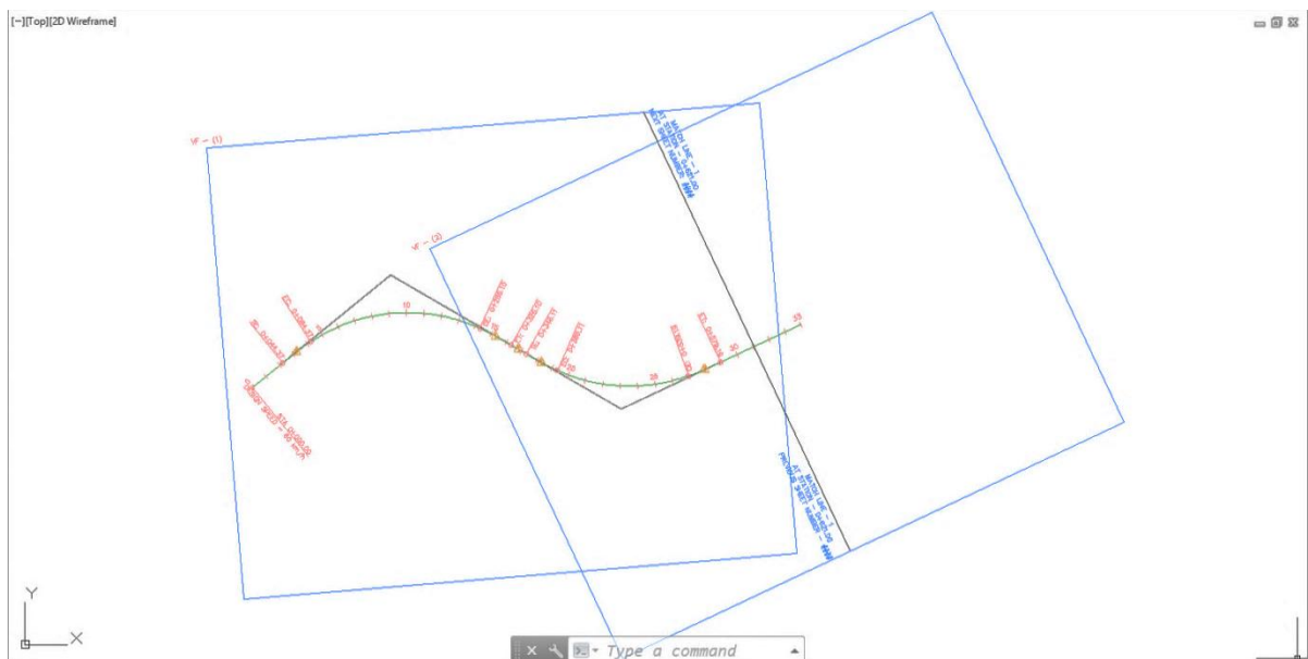
Figura 24 – Representação dos quadros de impressão sobre o eixo planimétrico
