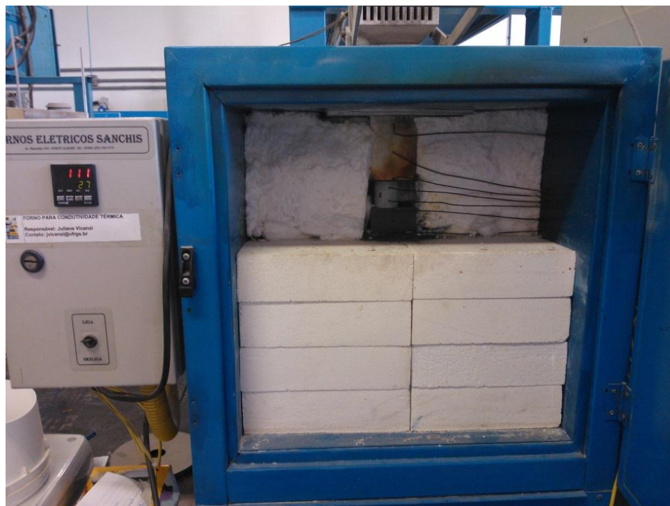
Figura 27 – Forno elétrico para ensaio de condutividade térmica
