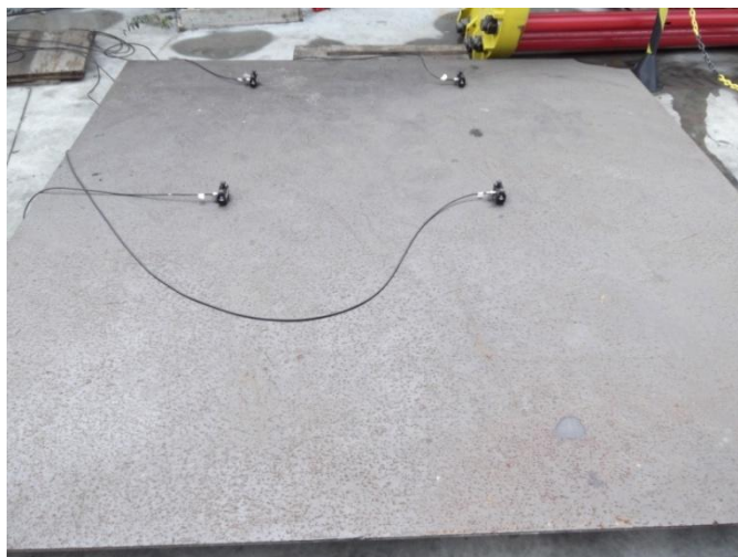
Figura 28. Chapa lisa de aço 12,7mm de espessura sem reforços e soldas utilizada no ensaio de localização.
