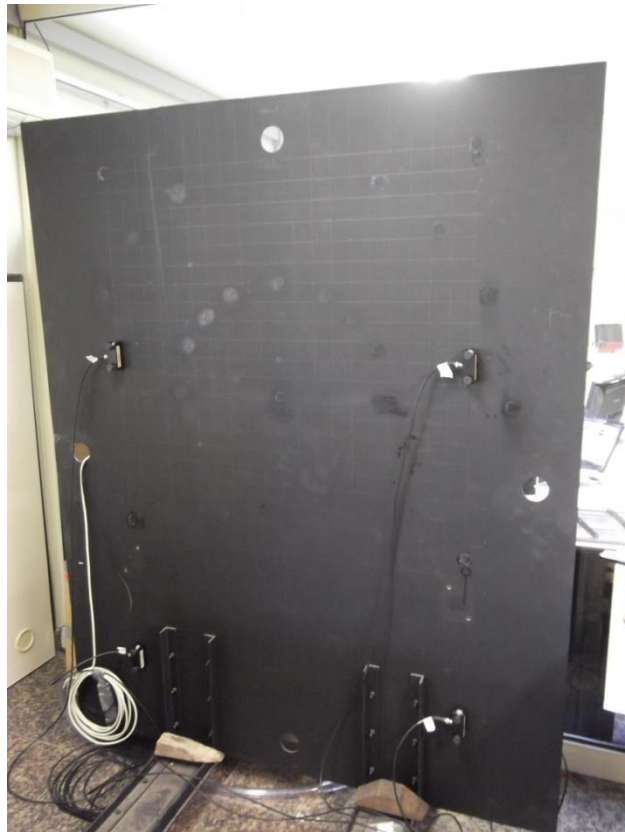
Figura 27. Chapa aço 5mm de espessura com reforços utilizada no ensaio de localização.
