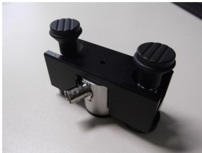
Figura 31. Prendedor magnético para acoplamento do sensor na peça de ensaio (VALLEN SYSTEME GmbH)
