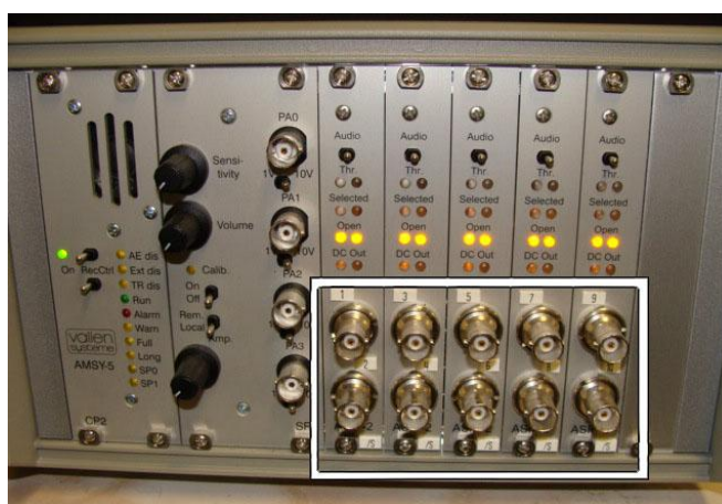
Figura 29. Sistema de aquisição AMSY-5 da Vallen Systeme, utilizado no ensaio de localização, indicando as entradas dos canais para conexão aos sensores.
