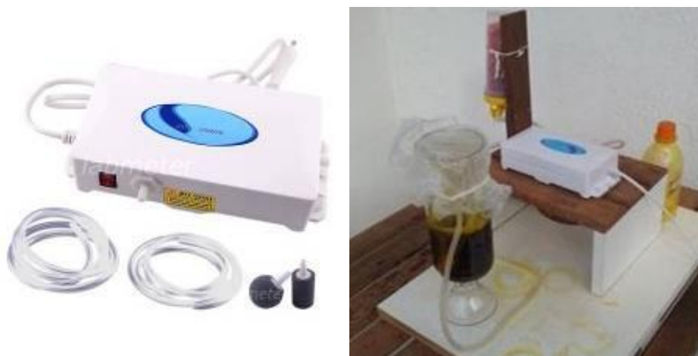
Figura 16 - Equipamento borbhador gerador de ozônio e aparato de oxidação das amostras via injeção e borbulhamento de ozônio.
