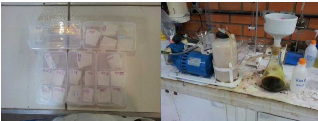
Figura 14 - Papéis filtro secos e identificados e procedimento de filtração da solução.
