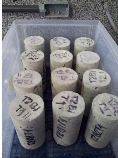
Figura 14 – Ensaio de absorção por capilaridade
