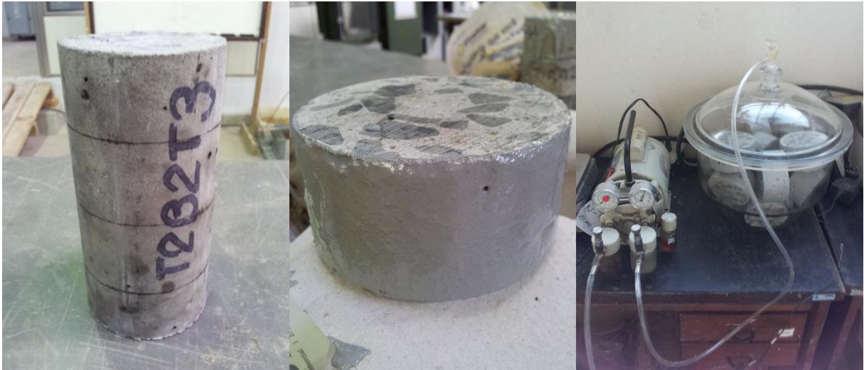
Figura 15 – Preparo dos corpos de prova para ensaio de migração de cloretos
