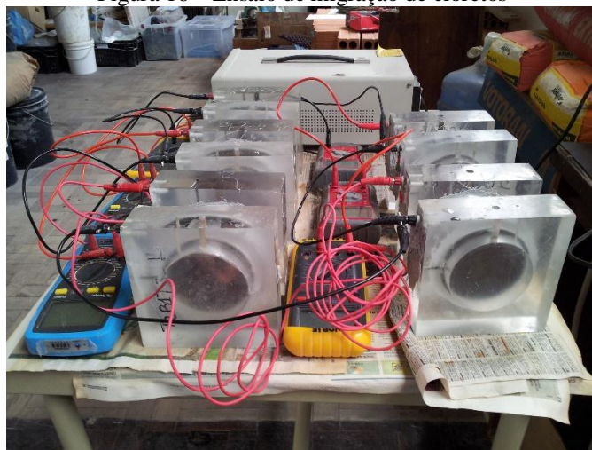
Figura 16 – Ensaio de migração de cloretos
