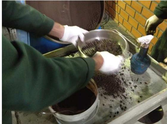
Figura 4.7 – Peneiramento das pelotas obtidas.
