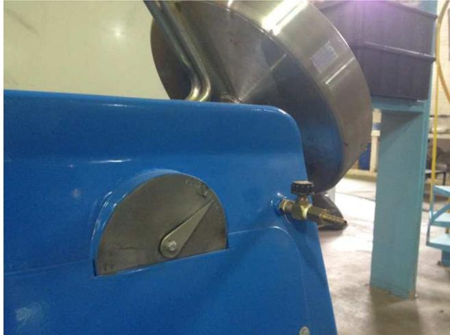
Figura 4.4 – Ângulo de inclinação do disco pelotizador.
