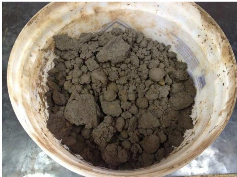
Figura 5.1 – Lodo formado na pelotização da amostra 12.
