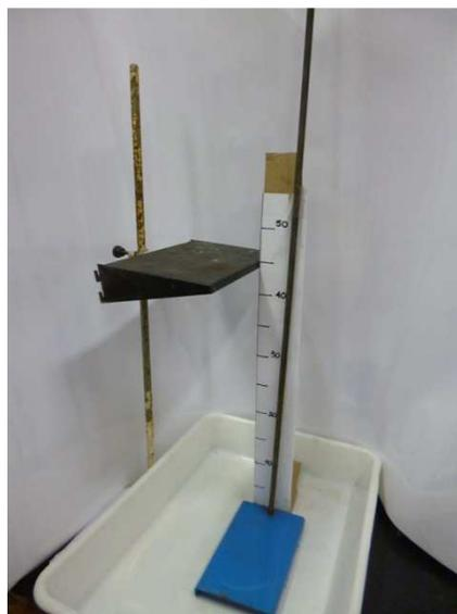
Figura 4.8 – Equipamentos do teste de queda.
