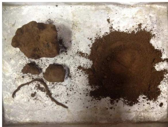
Figura 4.1 – PAE peneirado e materiais retirados.
