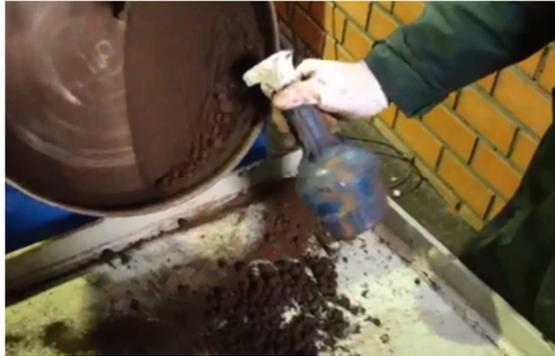
Figura 4.5 – Adição da água na pelotizadora através de um borrifador.
