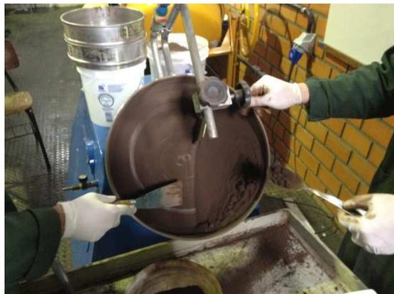
Figura 4.6 – Retirada das pelotas de maneira controlada.
