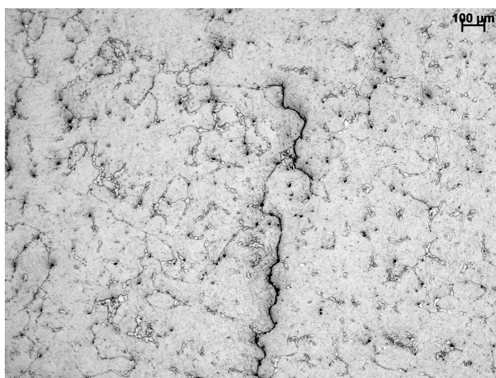
Figura 25 – Amostra 3, longitudinal. Sem ataque químico e objetiva de 5x, observa-se a presença de microvazios e coalescimento por fluência dos mesmos nas regiões dendríticas.
