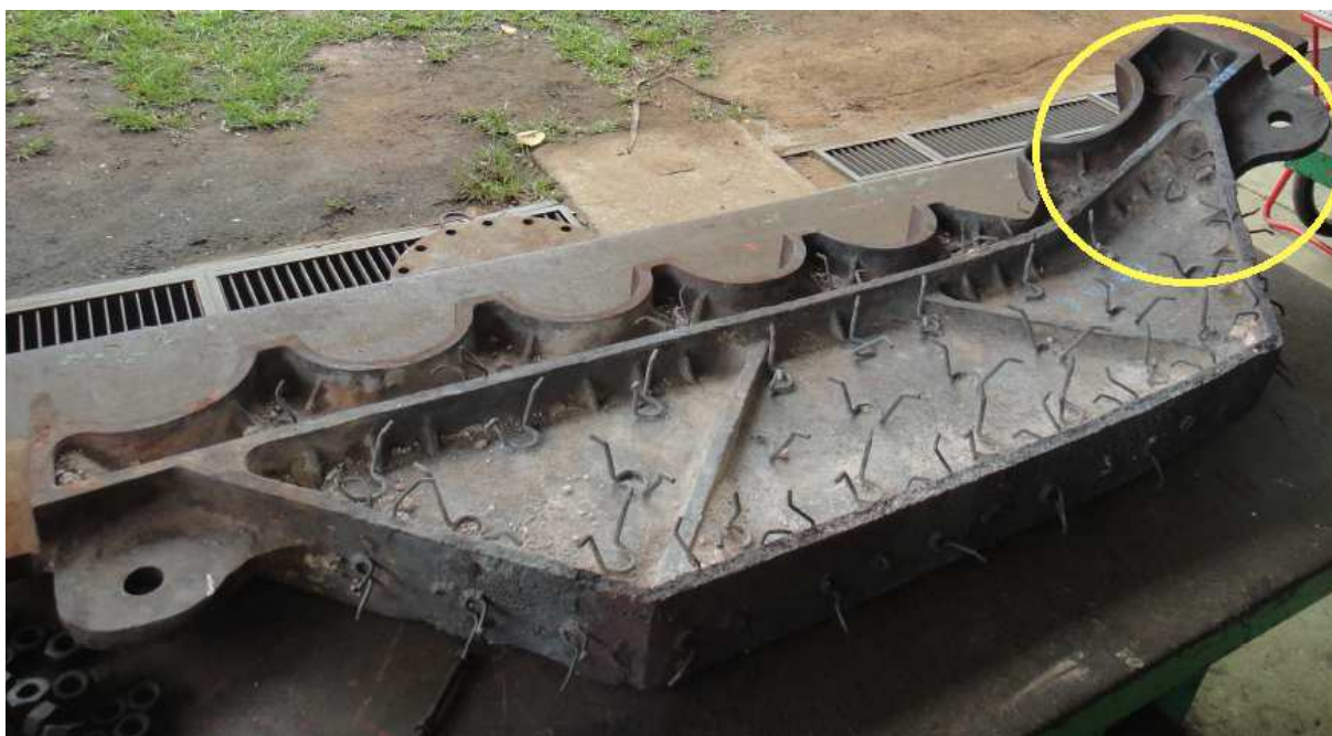
Figura 13 - Vista do módulo inferior do suporte intermediário da convecção deformado, o círculo em amarelo evidencia a deformação plástica do suporte.
