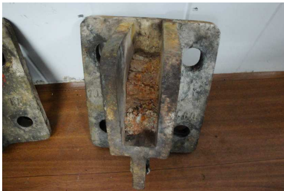
Figura 15 - Vista do res duo de refrat rio encontrado, fortemente compactado na regi o destinado   dilataç o térmica da guia do suporte.
