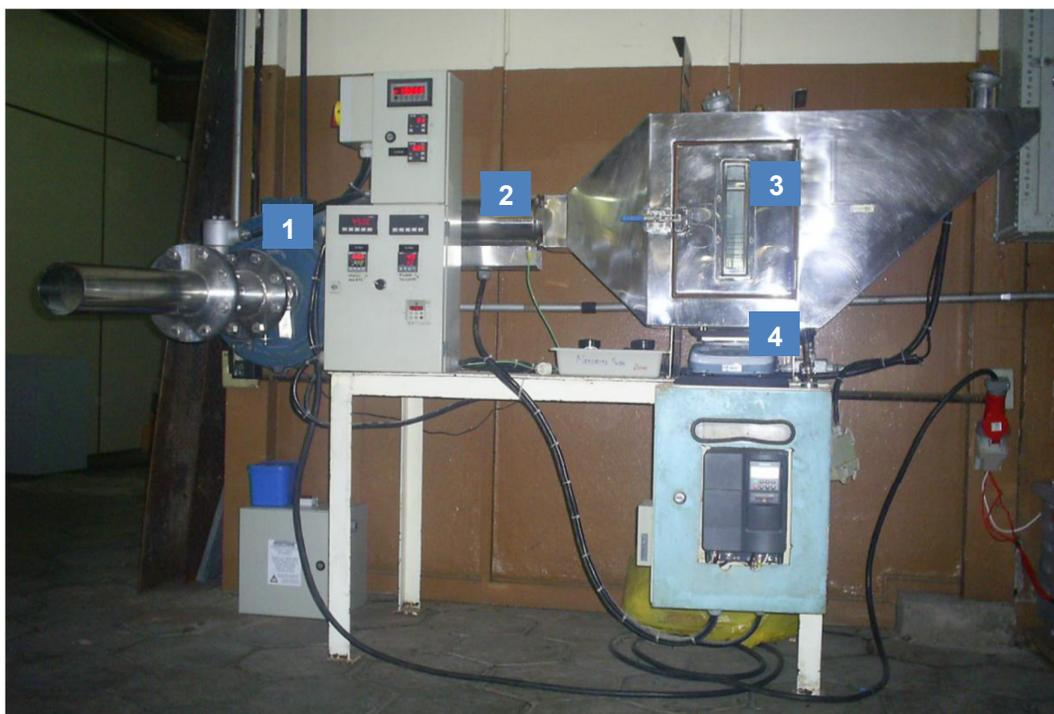
Figura 1: Secador de escala piloto utilizado, onde (1) Ventilador Centrífuco, (2) Resistências, (3) Cabine de secagem, (4) Balança (0,1 g de precisão). Fonte: Möhler (2010).
