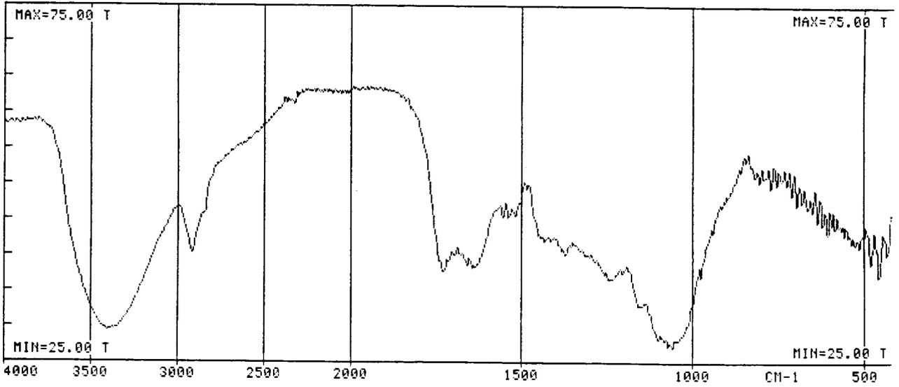
Figura 12. Espectro no infravermelho da biomassa da *Salvinia herzogii* na forma hidrogenada.
