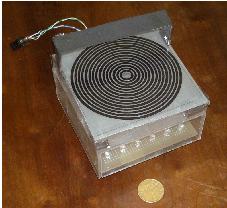
Figura A.3: Implementação do topografo proposto.
