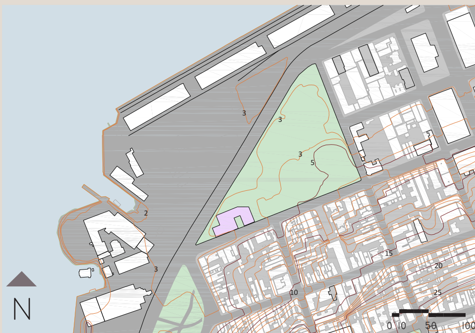
Levantamento Planialtimétrico do terreno.
